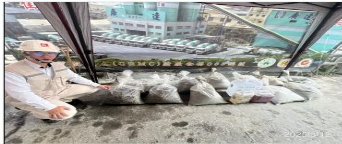
說明：廣達年度拌合材料取樣試驗暨預拌混凝土廠(114年度)驗廠作業。
