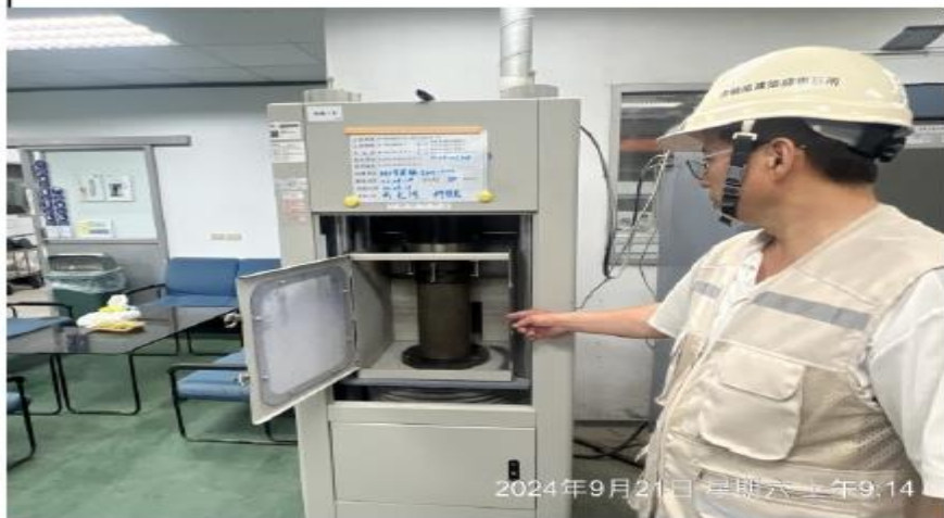
說明：混凝土試驗-B6F車道版Line:2~5。
